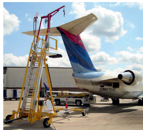
Echelles sur roues avec protection et points d'ancrage collectifs
