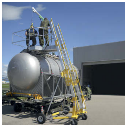
Echelles sur roues avec protection et points d'ancrage collectifs
