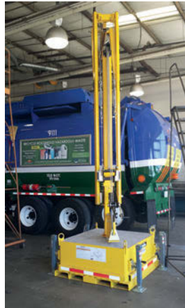
Mât d'ancrage mobile et dépliant
